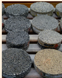
-Photo 1- Carottes de revêtements du projet.
